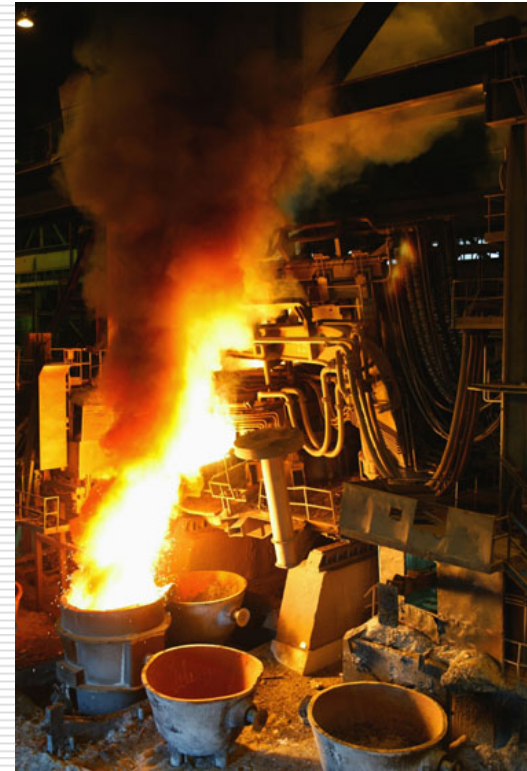
Tappning av råstål från ljusbågsugn till skänk. AB Sandvik Materials Technology, Sandviken Foto: Stig-Göran Nilsson (2002)
