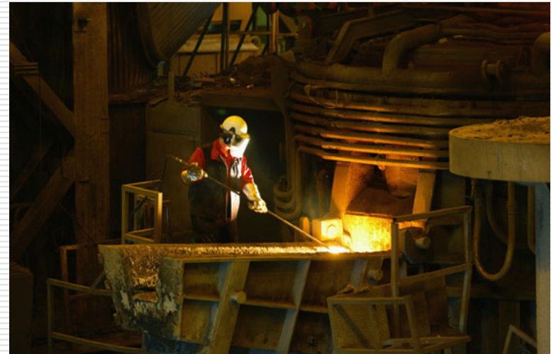
Förberedelse för tappning av ljusbägsugn. AB Sandvik Materials Technology, Sandviken. Foto: Stig-Göran Nilsson (2002)
